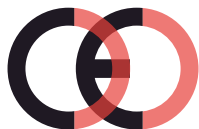
Falsk CE-mærke (for tæt på hinanden)
